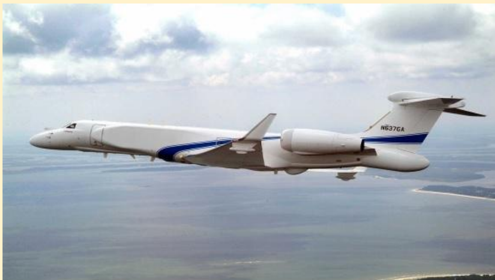
גרסה מוקטנת של מכ"ם סוקר אלקטרונית מורכב על מטוס גולפסטרים
