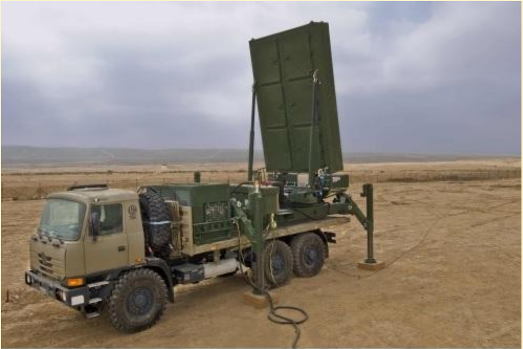
מכ"ם EL/M 2084 שהוא גרסה מוקטנת וניידת של מכ"ם אורן ירוק. המכ"ם מיועד להתריע ולהפעיל מערכות הגנה טקטיות כנגד רקטות בטווחים של עשרות קילומטרים.
