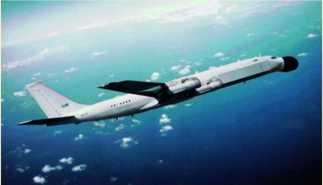
מכ"ם בקרה אווירית ואתראה מוקדמת CONDOR מותקן על גוף מטוס בואינג 707. המכ"ם מבוסס על 3 אנטנות – אחת קדמית ושתי אנטנות צמודות לגוף מימין ומשמאל. המכ"ם מבצע סריקת אלומה אלקטרונית בצידוד וסריקה באמצעות הסחת תדר בהגבהה.
