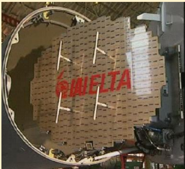
אנטנת מכ"ם מוטס המשלבת מערכת זיהוי עמית-טורף IFF
