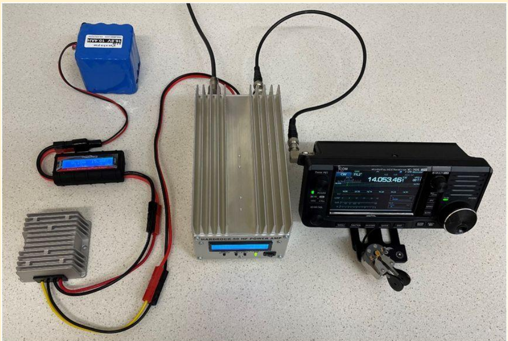
תחנת חובבים ניידת 50 ואט עם מארז תאי ליתיום NCA וממיר מתח לא נדרש ממיר מתח כאשר משתמשים במארז תאי ליתיום LFP
