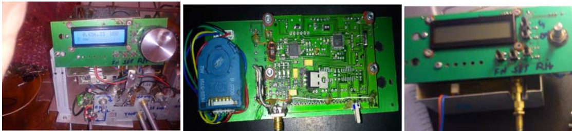
DDS בשלבים שונים – ממעגל מורכב עד הפעלה ראשונית של מקלט.
