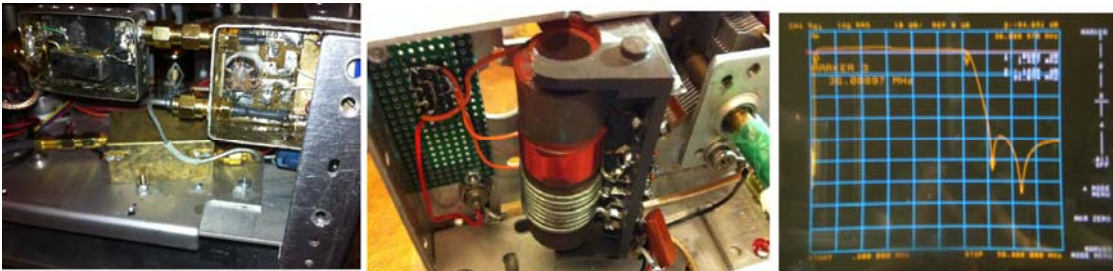
מדידת מסנן LPF, אנטנה טיונר של מקלט, מבנה של מנחת משתנה בבניה עצמית, למרות שמולחם על מעגל תעשיתי.
