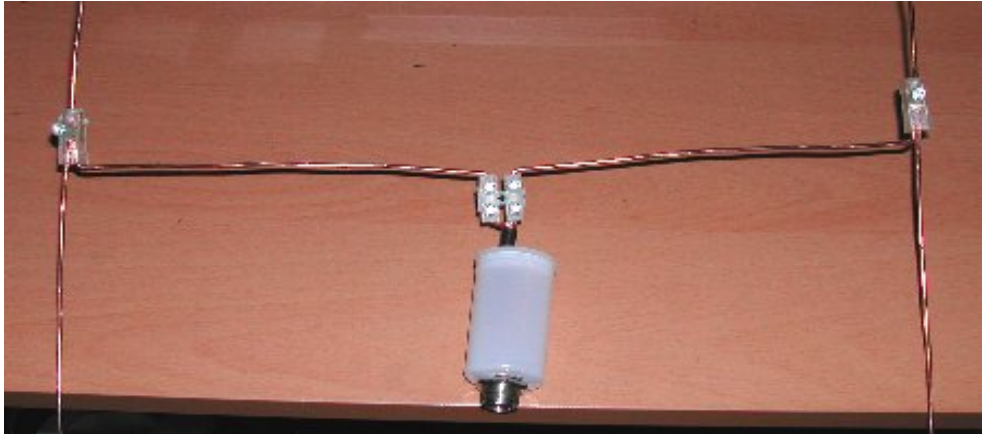
תמונה 3 : מערכת ההזנה בנקודה f בעזרת Balun וכיון התאים בנקודות a b ע"י "לוסטרה קלמות"
