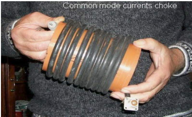
תמונה 2: RF Choke למניעת הפיכתו של הקואקס עצמו לאנטנה משררת. 10 ליפופים צמודים על צינור ביוב (חדש) 14-18 ס"מ אצל 4X4LH
